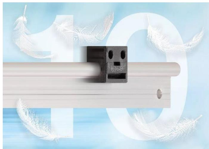
また、摩擦や摩耗が最適化された高機能ポリマーのイグリデュール JB を使用しているため、潤滑剤やメンテナンスが不要で、耐久性、耐粉塵性、耐汚性に優れています。ドライ運転時の摩擦係数が非常に低く、スティックスリップ現象が発生しにくいことも特長です。さらに、耐衝撃性と堅牢性を持ちながら、弾性と減振性も備えているため、振動を吸収して分散させることができます。イグスの社内試験施設での試験においては、25N までの荷重に耐えられることが実証済みです。
